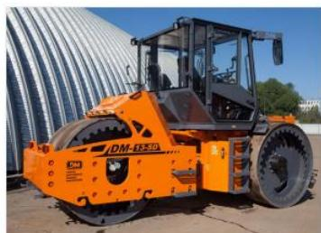
Улучшенный статический каток для дорожных работ DM-13-SD относится к категории самоходной строительной техники. Основная функция – уплотнение битумосодержащих слоёв при строительстве или ремонте дорог. Трёхвальцевый каток способен работать со слоями 25-50 мм. Работает при сложных условиях, отличается высокой производительностью и позволяет ускорить процесс строительства.
